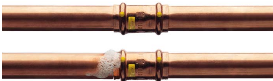
Rys. 8.5. Widok złąček szczelnej oraz z wykrytą nieszczelnością
