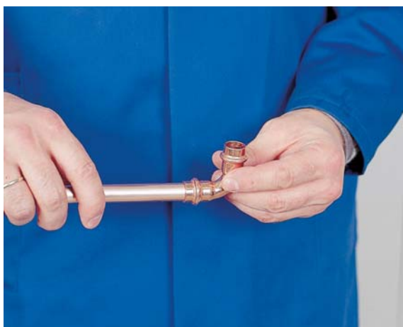
Rys.6.4.5. Ruchem obrotowym nasunąć łącznik na rurę do wyraźnie odczuwalnego oporu.
